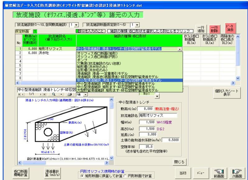
一定量差引モデルの他は、本指針の単位設計浸透量の計算式を使用して自動計算されます(水頭等によって浸透量が変化)。
