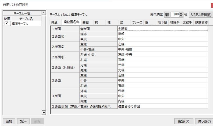
梁の定義の断面設定（全断面／端部・中央／左端・中央・右端／内端・中央・外端）の各位置の名称を設定します。
