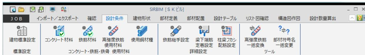
**建物標準設定**：部材の自動伸縮設定、鉄筋の継手・定着方法、鉄筋のかぶり寸法の初期値などを設定します
