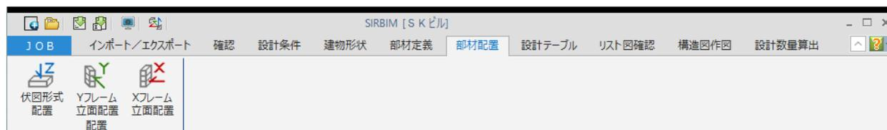
**Yフレーム立面配置**：Y軸を指定して配置します。見る方向（↑／↓）を指定しながら配置可能です
