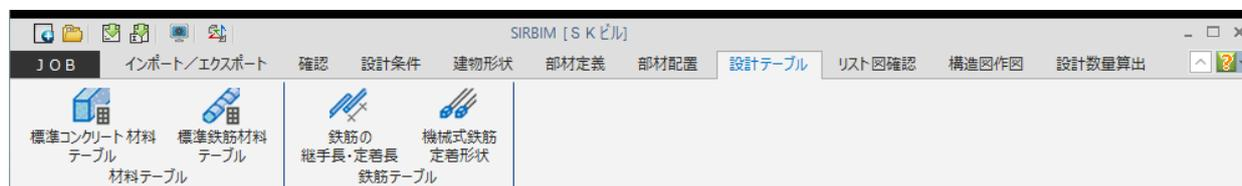
**標準コンクリート材料テーブル**：部材毎に、標準コンクリート材料を指定します。「設計条件」のコンクリートの標準材料で、このテーブル値を呼び出すことができます
