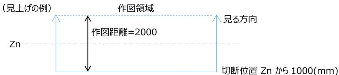
切断位置は、見る方向と反対方向に距離を取ります。
