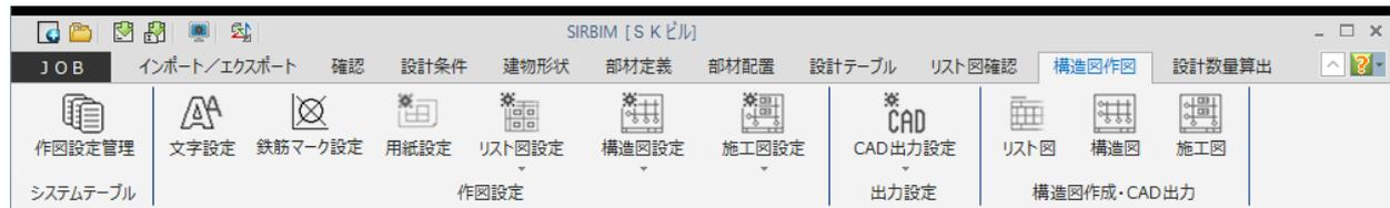
**作図設定管理**：作図時の設定テーブルを管理します。A 社用、B 社用などの作図テーブル管理が出来ます。
