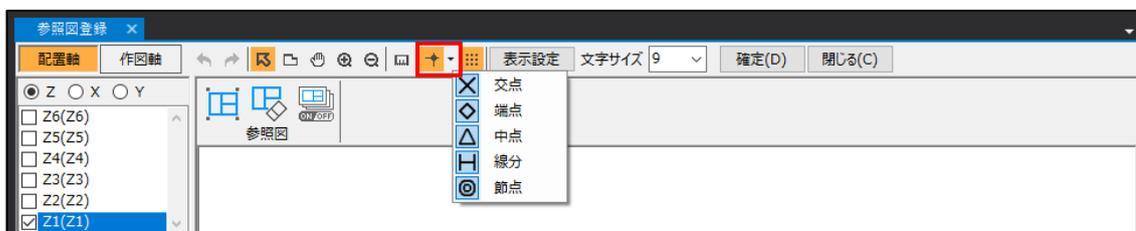
(2) 参照図を登録する Z/X/Y のいずれかのフレームを選択し、一度に登録する通り軸をチェックします。
