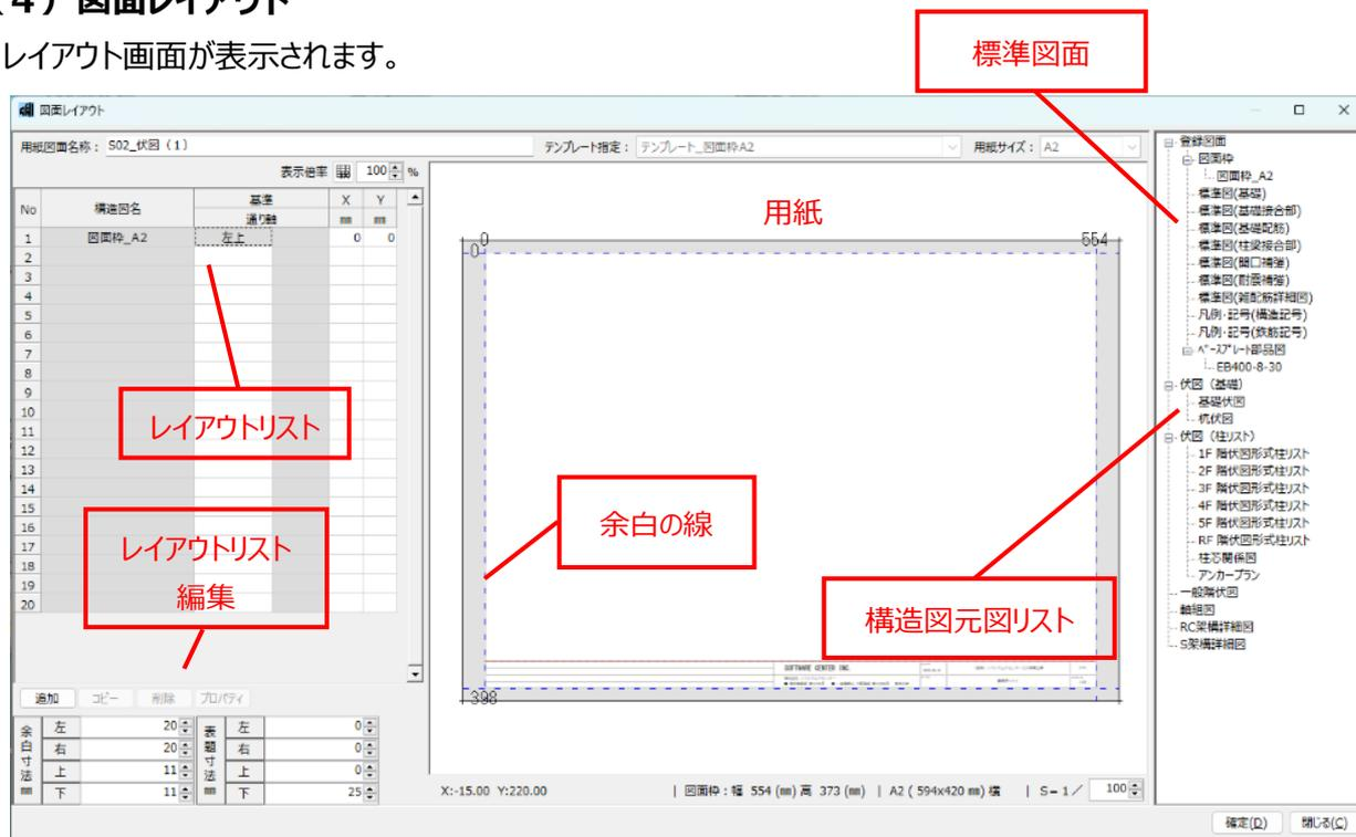
構造図元図リストには、一括作図済みの構造図（伏図、軸組図、詳細図）が表示されます。
