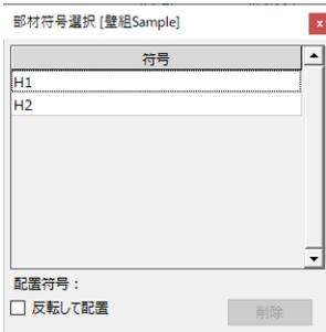
配置したい、「壁組符号」= H1を選択し、マウスで、配置したい位置に移動すると、仮表示されます。
