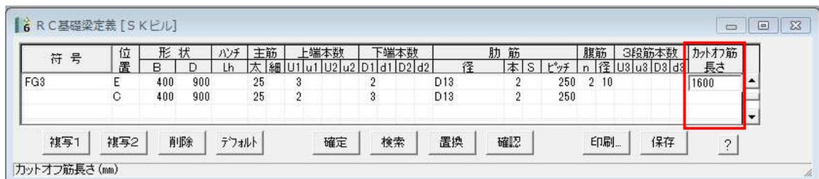
梁の部材定義で、カットオフ筋の長さを指定できるようになりました。断面リストにも反映されます。また、鉄筋数量にも反映されます。
